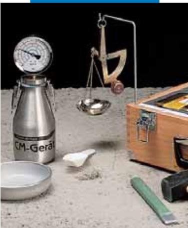
Medición de la humedad del recredido confeccionado con Mapecem con higrómetro de carburo
