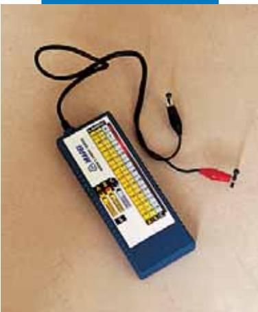
Medición de la humedad de los recredidos confeccionados con Mapecem con higrómetro electrónico MAPEI
